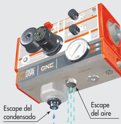
El aire del circuito se descarga mediante una salida en el lado inferior de la unidad equipada con silenciador. Si se desea transportar el aire de escape para evitar su emisión al ambiente, se puede sustituir el silenciador por una conexión conducida. (se recomienda una tubería con un diámetro mínimo de 6 mm) Junto a la salida de aire se encuentra la descarga de condensado que en la versión RA se puede conectar a la rosca con un record de 1/8".
